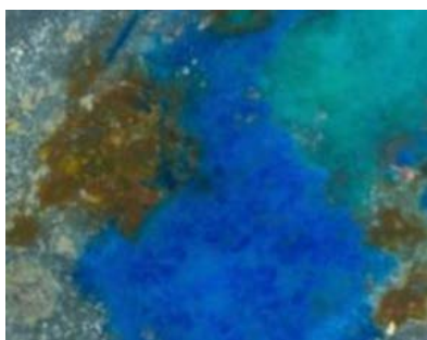
تصویر ۱۱. سنگ معدن مس با بلورهای مالاکیت و آزوریت. بافت قرمز رنگ در سمت چپ تمرکز آهن را اثبات می‌نماید، بزرگ‌نمایی ۱۰×. (نگارنده).
