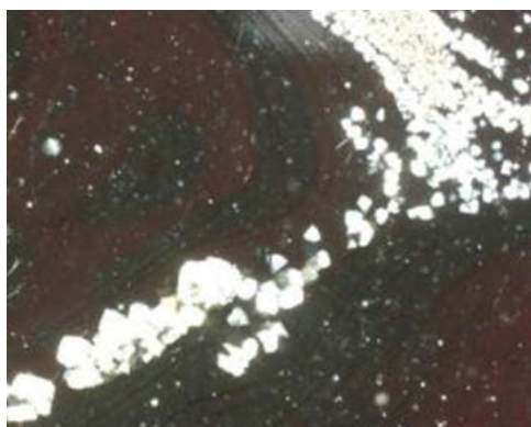
تصویر ۴. هرسینیت در بافت سوسپنسیون مس اکسیدی مقطع شماره NK533-1، بزرگ‌نمایی \times 5 . (نگارنده).
