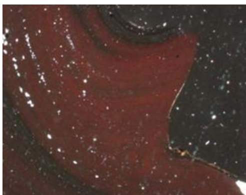
تصویر ۷. مس در حوضه تاریکی به صورت سوسپانسیون، در کناره‌های مس هاله‌های کوپریت را می‌توان به وضوح ملاحظه کرد، بزرگ‌نمایی \times 10 . (نگارنده).
